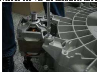
Dévisser les vis de fixation moteur
