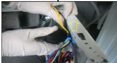
Démonter le pressostat EPS
