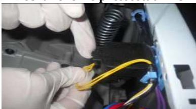
Débrancher le pressostat EPS
