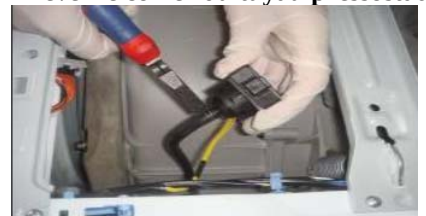
Enlever le collier du tuyau pressostat
