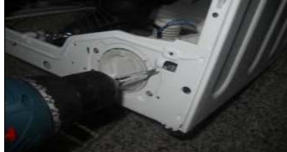
Débrancher la résistance
