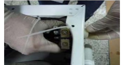
Débrancher le filtre anti-parasite
