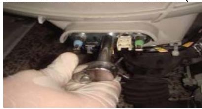
Démonter le collier joint de hublot
