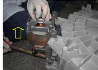
Démonter le moteur
