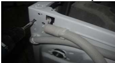
Débrancher le pressostat EPS
