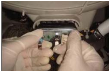
Dévisser les vis du contre-poids supérieur
