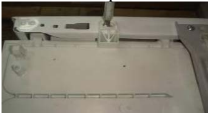
Démonter les 2 vis de l'anti-parasite
